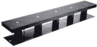
Der wasserdichte induktive Flächenschalter IFE 900/150 GSP erzeugt ein schlankes senkrecht nach oben gerichtetes Feld und erreicht Schaltabstände bis 200 mm (Bilder: EGE/gii)
