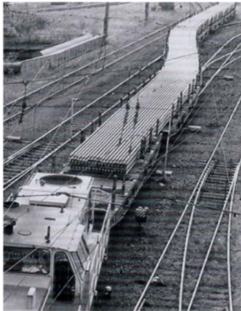
Mit einer Länge von bis zu 120 m liefert die Thyssen Schienen Technik GmbH Schienen in alle Welt.
