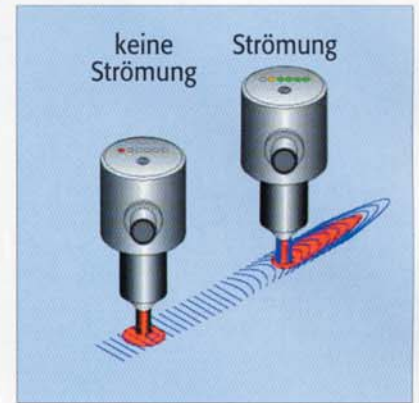
Bild 4. Thermodynamisches Prinzip zur Messung der Strömungsgeschwindigkeit links Aufheizung ohne Strömung rechts Aufheizung durch Strömung
